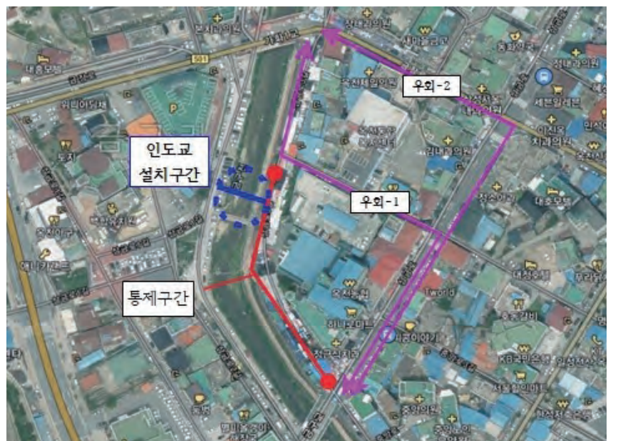
금구천 인도교 설치 공사로 인한 통제 구간 및 우회로.
